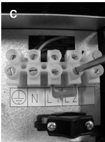
Рисунок 10 С и D. 1-фазное соединение каменки
